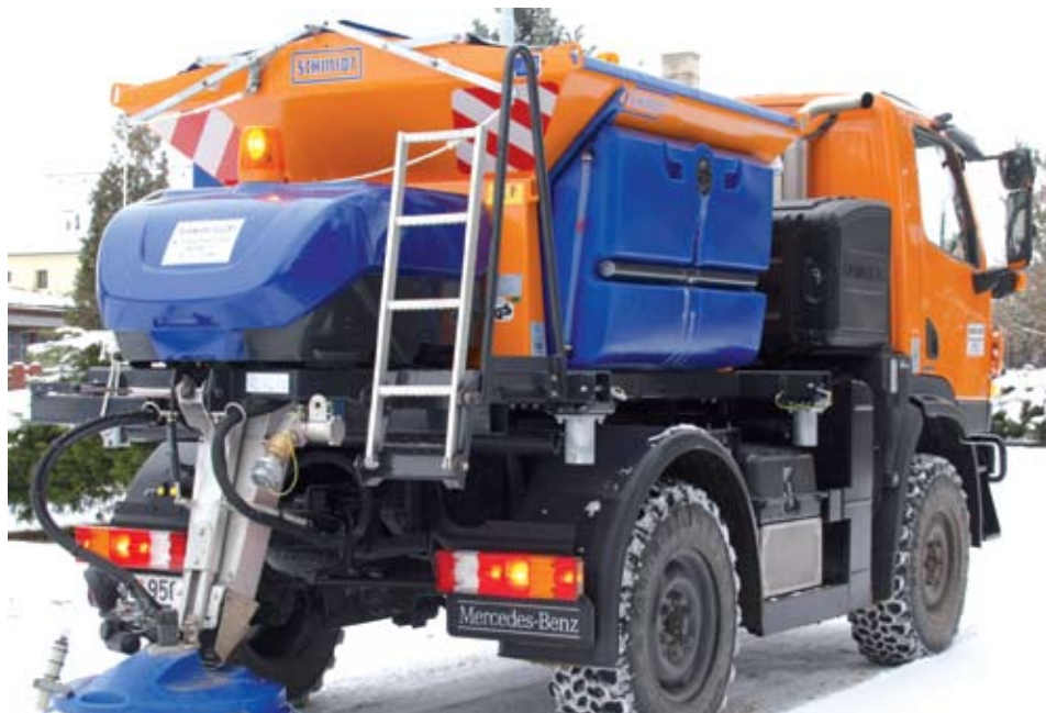
Nově dodaný Unimog od Mercedesu má mj. pohon na všechna čtyři kola a rovněž umožňuje aplikaci tzv. vlhčené soli, u které je nástup účinku podstatně rychlejší než při klasické aplikaci.
